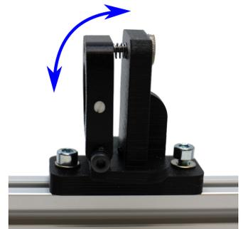
Auch in der Horizontalen können Höhenanpassungen nötig sein, indem beispielsweise die Zeilenkamera im unteren Bild mittels Federn und Schrauben gekippt wird, um an den Strahlengang des Experimentes angepasst werden zu können. Dieses Bild zeigt die Höhenverstellung ohne Verkleidung, welche auch als Führung dient und Halt gibt.
