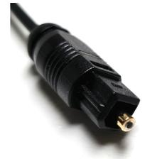
TOSLINK (kurz für TOSHIBA-LINK) ist ein ursprünglich von Toshiba entwickeltes, standardisiertes Lichtwellenleiter-Verbindungssystem für optische Signalübertragungen. Weite Verbreitung hat es durch die Benutzung bei der digitalen Übertragung von Audiosignalen bei Konsumgütern gefunden, wo es zum Beispiel zur Übertragung zwischen Komponenten wie CD- und DVD-Spielern und Audioverstärkern oder D/A-Wandlern benutzt wird.
