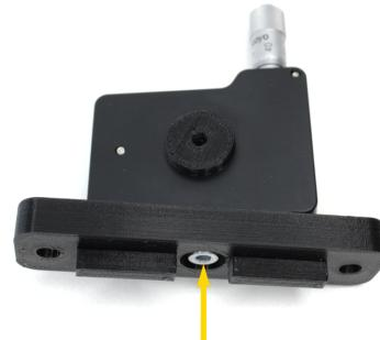
Jeweils eine Zylinderkopfschraube SM-5x14 mit Unterlegscheibe WA-M5 von oben durch die verbleibenden Befestigungslöcher stecken. Hiermit wird das Modul dann später auf dem Profil verschraubt.
