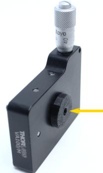
Den Spalt VA100/M auf die glatte Seite der Basisplatte 3D-0060 setzen und von unten mit der Zylinderkopfschraube SM-4x8 sowie der Unterlegscheibe WA-M4 durch das mittlere Befestigungslöch der Basisplatte verschrauben. Die Schraube so stark anziehen, dass der Spalt nicht wackelt, aber dennoch mit leichtem Kraftaufwand zur genauen Ausrichtung auf der Basisplatte etwas gedreht werden kann.
