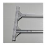
Profil D an B und C schrauben: Analog zum vorhergehenden Schritt werden hier wieder je zwei Nutensteine in der seitlichen Nut von Teil D und je eines in den Seitennuten der Teile A und B benötigt. Vor dem Zusammensetzen müssen allerdings noch jeweils zwei Nutensteine in die obere Nut von Teil B und C eingesetzt werden (hier werden später Module aufgesetzt).
