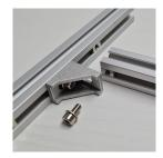
Die exakten Abstände zwischen den Profilen B und C werden später beim Aufbau des Spektrometers noch eingestellt, es sollte aber schon beim ersten Zusammenbau darauf geachtet werden, dass sich alle Profile im rechten Winkel zueinander befinden und der fertig aufgebaute Rahmen ohne zu kippeln auf der Unterlage liegt.
