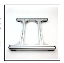
Kappen am Ende der Profile dienen nicht nur der Ansehnlichkeit des Aufbaus, sondern verhindern vor allem, dass nicht genutzte, unfixierte Nutensteine z.B. beim Transport verloren gehen. Bodenkappen mit Gummipuffer an der Unterseite dämpfen Erschütterungen von außen und sorgen für einen sicheren Stand des Aufbaus, so dass der Aufbau beim Justieren nicht so leicht verrutscht. Das nebenstehende Bild zeigt einen Beispielaufbau mit montierten Modulen für ein Czerny-Turner-Spektrometer.
