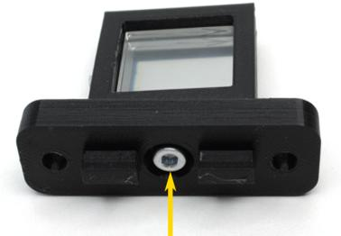
Jeweils eine Zylinderkopfschraube SM-5x14 mit Unterlegscheibe WA-M5 von oben durch die verbleibenden Befestigungs Löcher stecken. Hiermit wird das Modul dann später auf dem Profil verschraubt.
