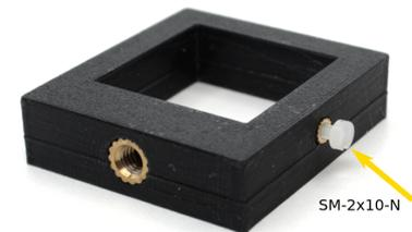
Den Halter mit dem verbliebenen Gewindeeinsatz mittig auf die glatte Oberseite der Basisplatte 3D-0040 setzen und von unten mit der Zylinderkopfschraube SM-4x8 sowie der Unterlegscheibe WA-M4 durch das mittlere Befestigungsloch verschrauben. Die Schraube so stark anziehen, dass der Spalt nicht wackelt, aber dennoch mit etwas Kraft zur Ausrichtung auf der Basisplatte etwas gedreht werden kann.
