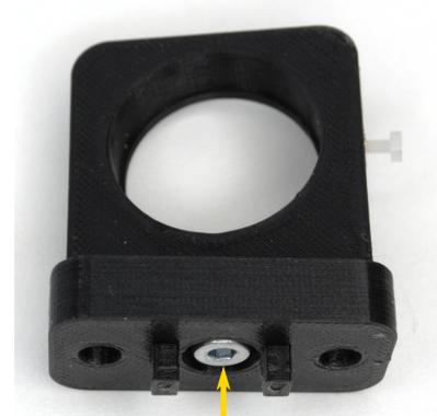
Jeweils eine Zylinderkopfschraube SM-5x14 mit Unterlegscheibe WA-M5 von oben durch die verbleibenden Befestigungslöcher stecken. Hiermit wird das Modul dann später auf dem Profil verschraubt.
