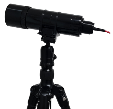
Sucherfernrohr mit Lichtleiter auf Stativ
