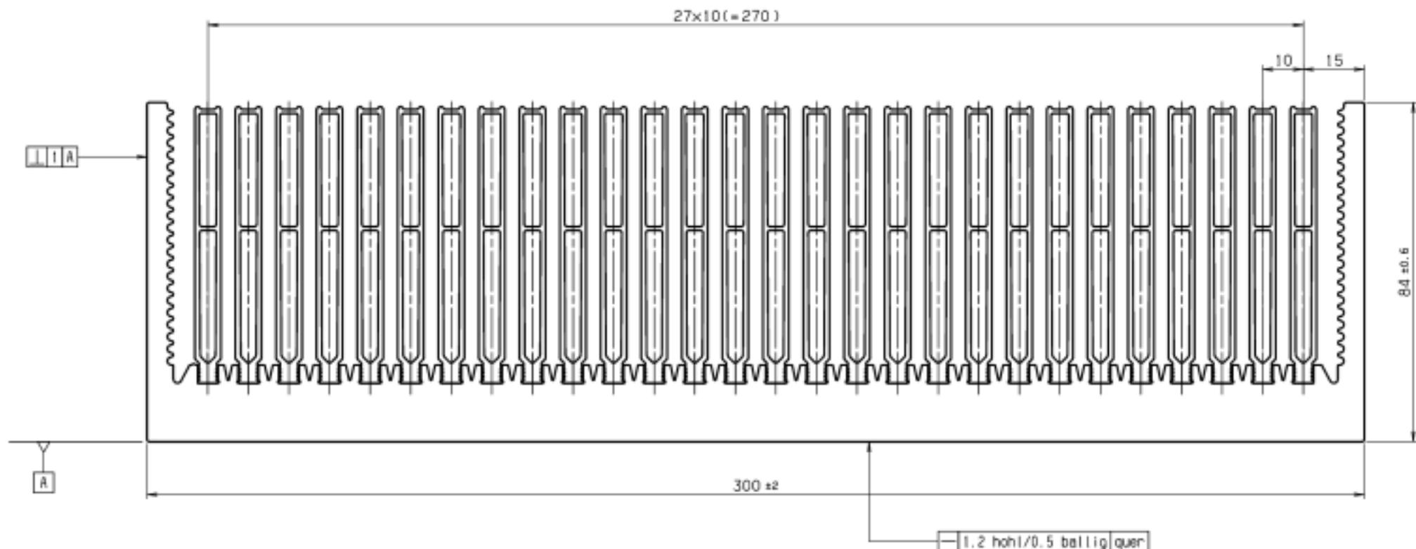
Die den verschiedenen Kühlkörpertypen zugeordneten Wärmewiderstände sind lediglich Richtwerte bei großflächiger Wärmeverteilung. Sie können Messungen unter praxisnahen Bedingungen, worunter besonders Anzahl und Anordnung der Wärmequellen zu verstehen sind, nicht ersetzen.
