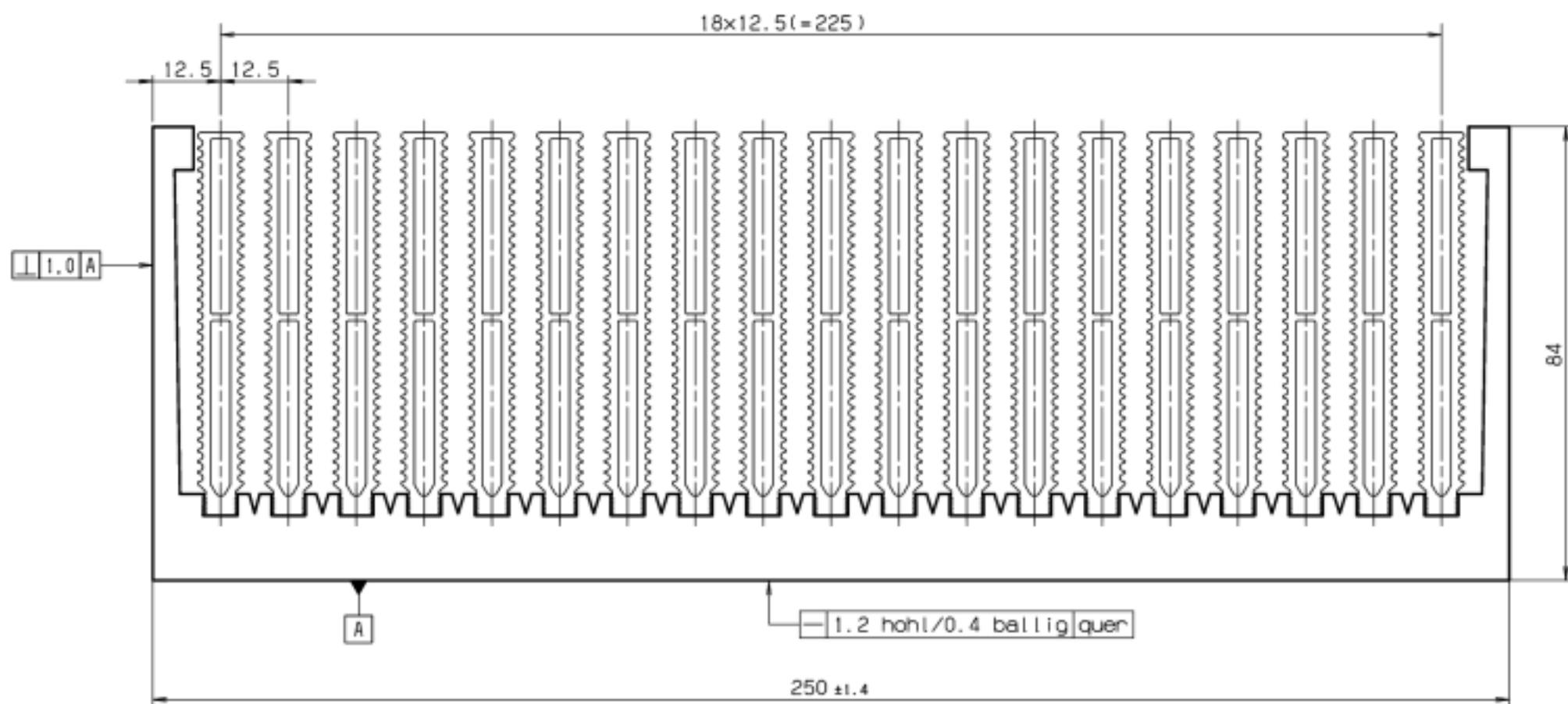
Die den verschiedenen Kühlkörpertypen zugeordneten Wärmewiderstände sind lediglich Richtwerte bei großflächiger Wärmeverteilung. Sie können Messungen unter praxisnahen Bedingungen, worunter besonders Anzahl und Anordnung der Wärmequellen zu verstehen sind, nicht ersetzen.
