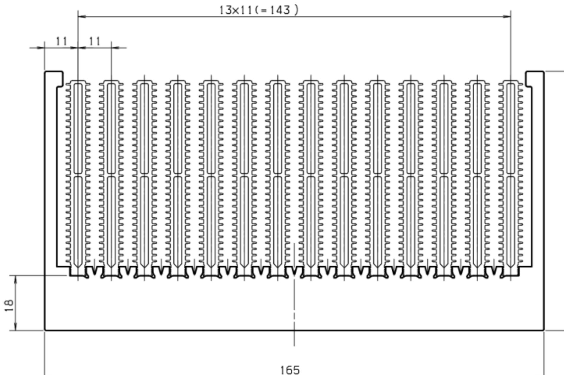
Die den verschiedenen Kühlkörpertypen zugeordneten Wärmewiderstände sind lediglich Richtwerte bei großflächiger Wärmeverteilung. Sie können Messungen unter praxisnahen Bedingungen, worunter besonders Anzahl und Anordnung der Wärmequellen zu verstehen sind, nicht ersetzen.
